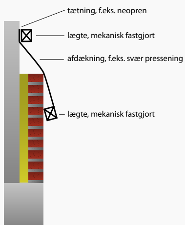
Fig. 17. Afdækning af skalmur under opførelse.
