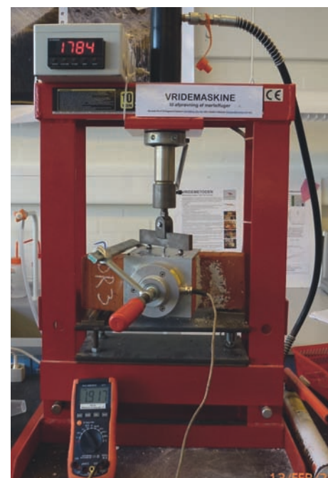
Figur 4. På DTU - BYG er en prototype af en forholdsvis enkel, transportabel 'vridemaskine' udviklet. Det er tanken, at maskinen skal kunne anvendes på mørtel- eller teglværker, så det kan vurderes, om en mørtel passer sammen med en given sten 1)
