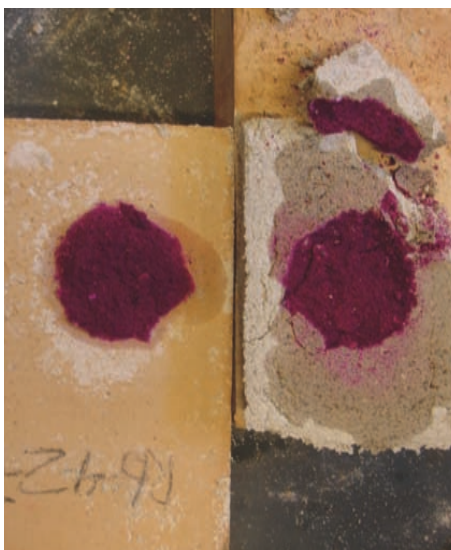
Figur 9. Karbonatiseringens dybde i prøverne blev målt efter brud ved påsprøjtningen af indikatoren phenolphthalein
